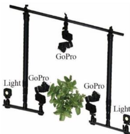
شکل ۱- تنظیم تصویر برداری. تصاویر گیاه، همزمان توسط سه دوربین ویدئویی قابل حمل برداشته می‌شوند.
